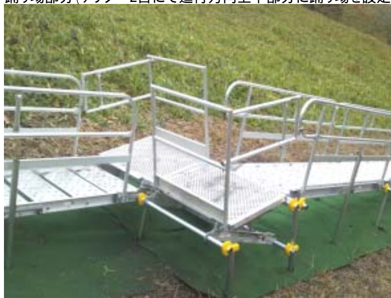
踊り場部分 (ノリダー2台にて進行方向上下部分に踊り場を設定)
