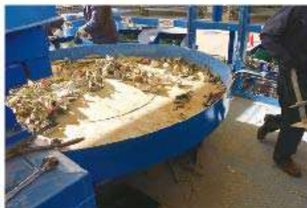
回転テーブルによる作業員の移動短縮
