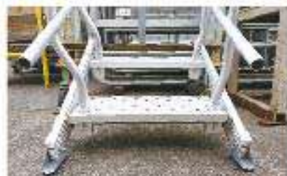
手すり設置状態
