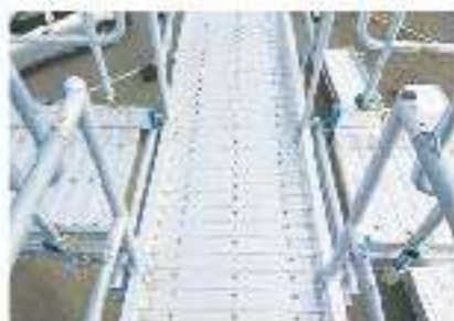
開口部手摺り枠使用による従来機種との連結状態
